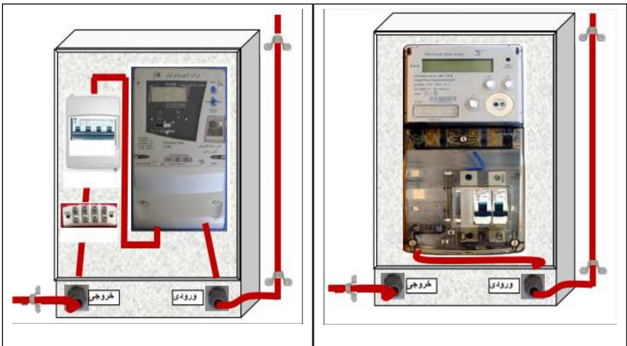
شکل 6 نحوه نصب تابلو و کنتور و کابل سه فاز
